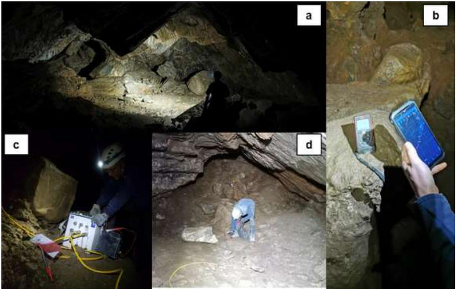
Panoramica delle condizioni ambientali del sottosuolo della grotta di Borna Maggiore (a) e degli strumenti utilizzati per i rilievi topografici (b) e geofisici (c-d). Fonte e proprietà delle immagini: autori dell'articolo
